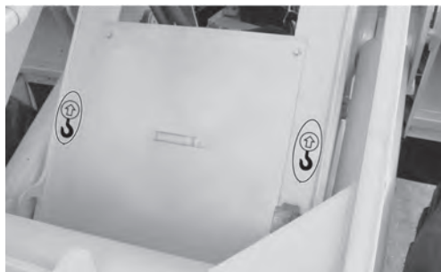
Рисунок 1.13 — Расположение знаков «Место строповки» на передней полураме
