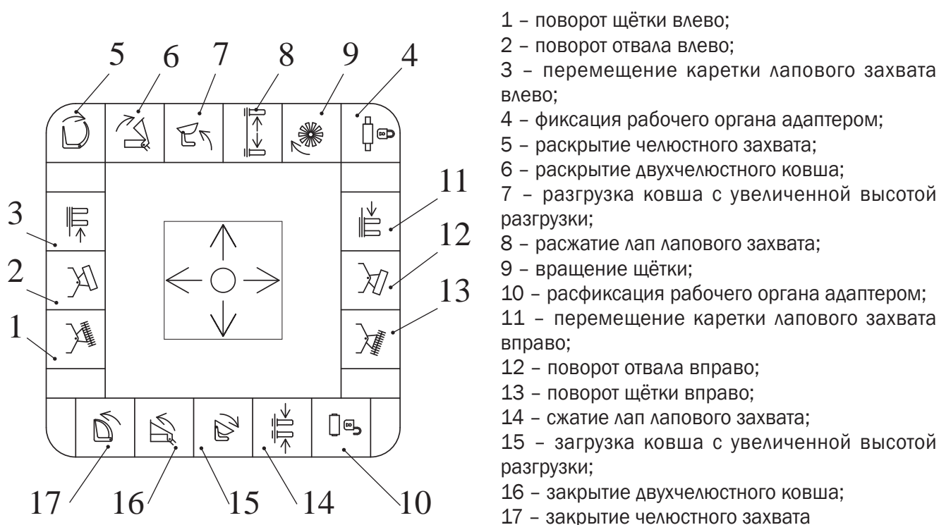
Рисунок 2.14 — Табличка управления рабочими органами погрузчика универсального
